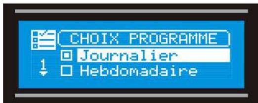
Ce menu permet de choisir le type de fonctionnement du régulateur en se déplaçant avec les flèches ↑ et ↓ puis en validant avec .
