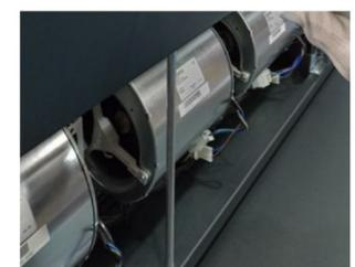
4- Retirez les vis et les équerres de fixation de la batterie.
