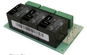
Pour les modèles 30 kW et + (G-ECG-SB-BB), le contrôle des 3 étages de chauffe se fait par l'intermédiaire de 2 contacteurs
