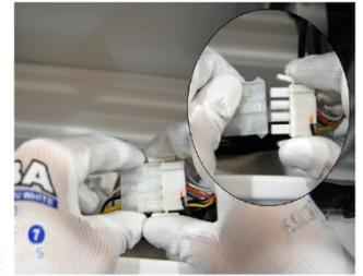
Identifier et déconnecter les câbles du ventilateur du faisceau d'alimentation générale provenant de la carte électronique. Retirer le ventilateur en desserrant les deux vis de fixation (une de chaque côté) et monter le ventilateur de remplacement en suivant le processus dans l'ordre inverse.
