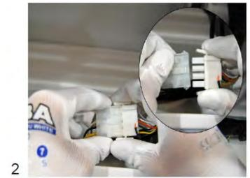
Identifier et déconnecter les câbles du ventilateur du faisceau d'alimentation générale provenant de la carte électronique. Retirer le ventilateur en desserrant les deux vis de fixation (une de chaque côté) et monter le ventilateur de remplacement en suivant le processus dans l'ordre inverse.
