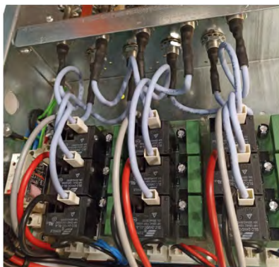
Type de raccordement pour tous les modèles M-ECM et pour les modèles G-ECG taille 1000/1500 (avec 3 platines PRBEO)
