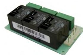
Pour les modèles 30 kW et + (G-ECG-SB-BB), le contrôle des 3 étages de chauffe se fait par l'intermédiaire de 2 contacteurs
