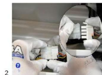
Identifier et déconnecter les câbles du ventilateur du faisceau d'alimentation générale provenant de la carte électronique. Retirer le ventilateur en desserrant les deux vis de fixation (une de chaque côté) et monter le ventilateur de remplacement en suivant le processus dans l'ordre inverse.
