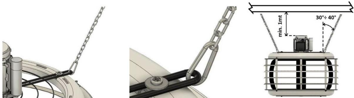
Les points d'ancre doivent être suffisamment espacés afin d'absorber le couple de démarrage de l'appareil.
