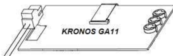
Raccordement vers l'aérotherme
