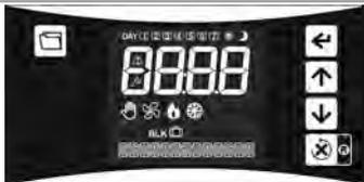
**NOTA:** l'écran du XCERK-CM300 réduit automatiquement l'éclairage après 10s. d'inactivité sur le clavier. (Voir le par. **L19** au paragraphe n°8) Appuyer sur n'importe quel bouton pour éclairer de nouveau l'écran.
