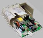
Module électronique analysant en permanence la qualité de l'eau et contrôlant les différents composants du rafraichisseur
