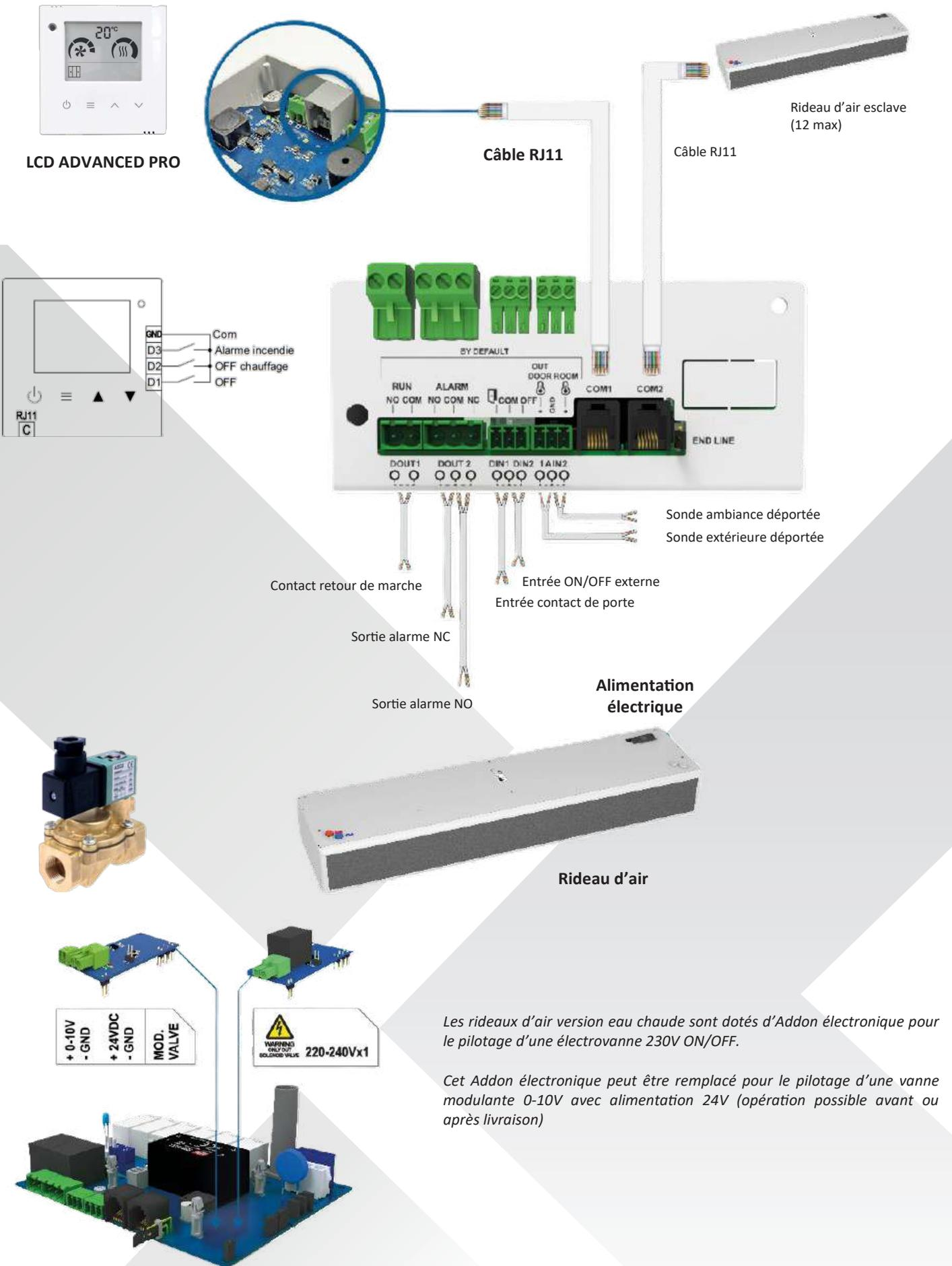
Les rideaux d'air version eau chaude sont dotés d'Addon électronique pour le pilotage d'une électrovanne 230V ON/OFF.
