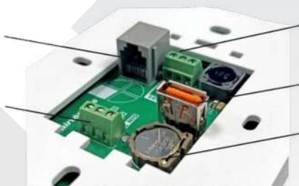
Connexion Modbus A+ B- GND
