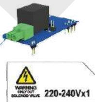
Les rideaux d'air version eau chaude sont dotés d'Addon électronique pour le pilotage d'une électrovanne 230V ON/OFF.
