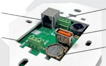
Connexion Modbus A+ B- GND
