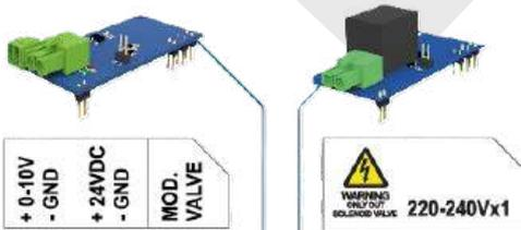
Les rideaux d'air version eau chaude sont dotés d'Addon électronique pour le pilotage d'une électrovanne 230V ON/OFF.
