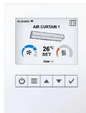
Raccordement au rideau d'air chaud avec câble RJ11 4 fils droit, comme pour le LCD ADVANCED PRO
