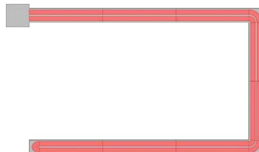
Module double de largeur 800 tube  $\varnothing 200$
