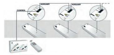
Un boitier de commande standard peut piloter jusqu'à 12 rideaux d'air simultanément
