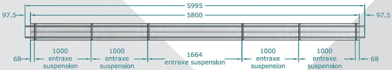
Configuration avec entrée et sortie en eau du même côté
