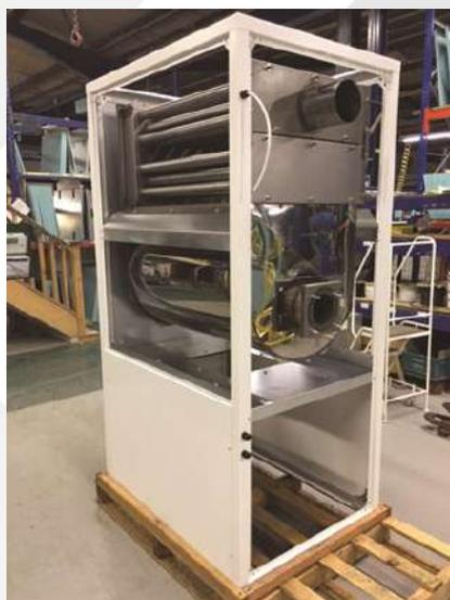
Générateur d'air chaud livré démonté/remonté
