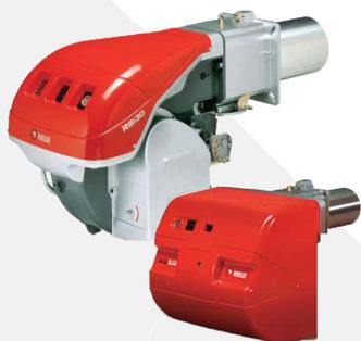
Préréglage usine à 20 mbar. Pour une pression d'alimentation en 300 mbar prévoir un kit incluant un réducteur de pression ajustable et un filtre en amont du brûleur (Kit à fournir par l'installateur).
