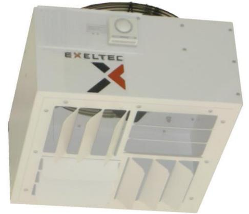
Destratificateur d'air chaud thermostaté avec ventelles directionnelles 4 flux, groupe moto-ventilateur spécial ErP 2015 Ziel Abeg/ebm-papst avec pâles à haut rendement, haut débit et faible niveau sonore, peinture poudre polyster en application électrostatique et traitement thermique couleur blanc RAL9003. Eligible aux Certificats d'Economie d'Energie.
