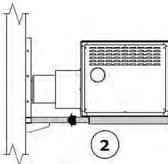
Siliconer sur les parties latérales et supérieures le bord de l'unité de combustion afin de prévenir toute infiltration d'eau à travers le trou de pénétration en paroi.
