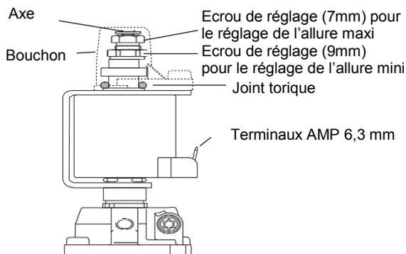
dans le sens des aiguilles d'une montre pour augmenter la pression (ou inversement pour
