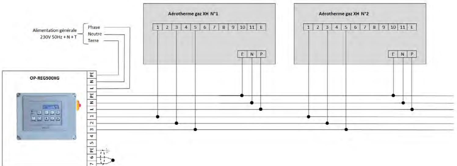
**VI.6.11 Schéma de raccordement thermostat OP-REG500XG et aérothermes XH modulants (2 à 4 aérothermes selon modèles)**
