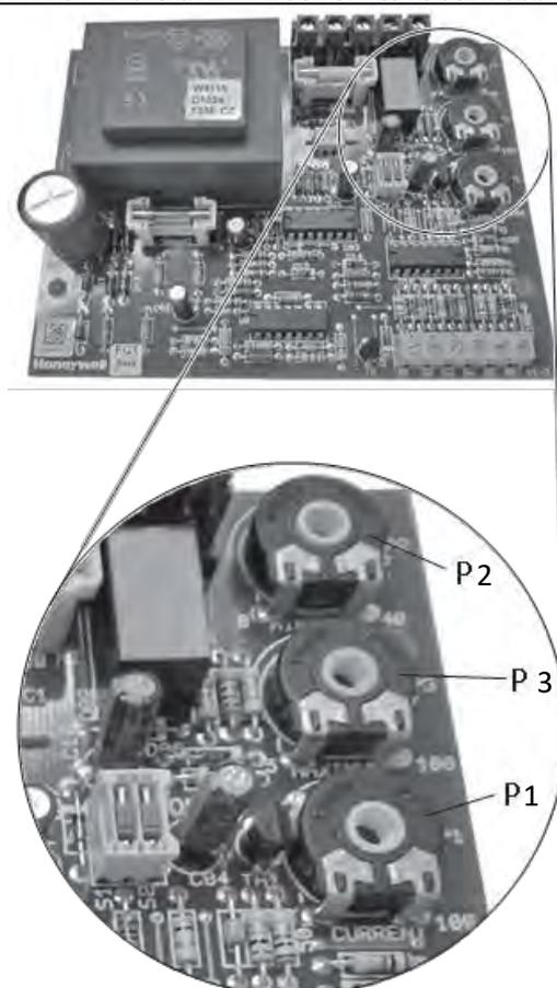
Sur cette version (version 1), la platine interface convertit un signal 0-10V DC en provenance de la régulation et le retransmet à l'électrovanne modulante. Paramètres de réglage :
