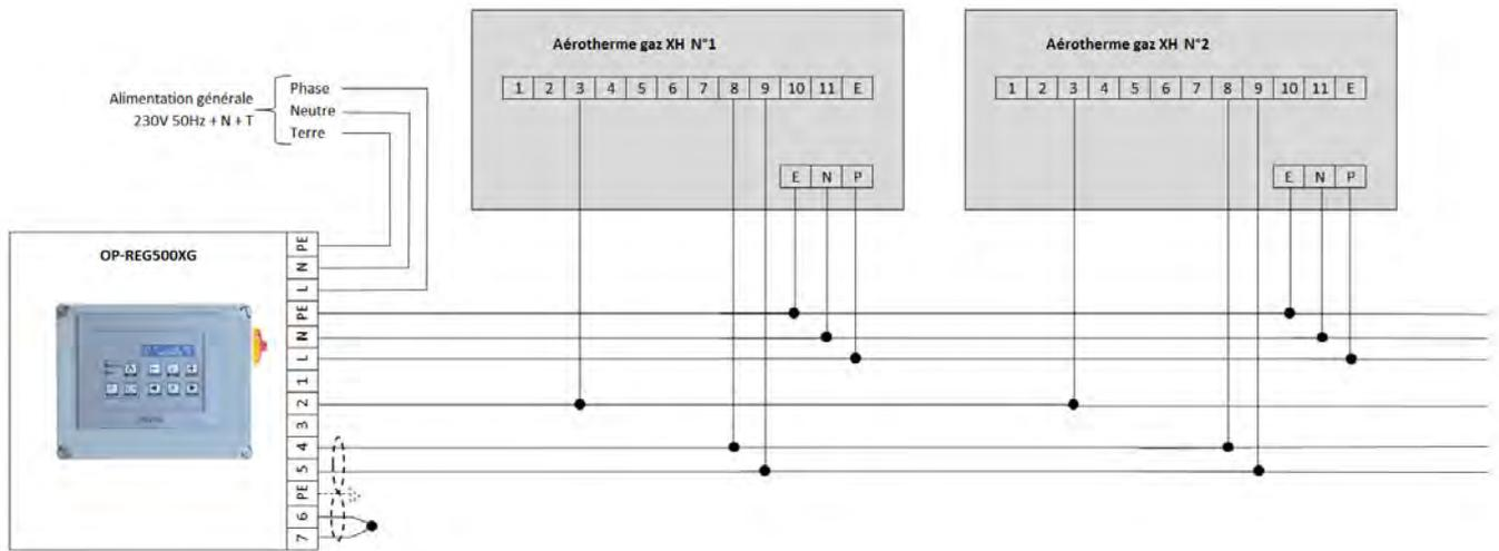
**VI.6.12 Schéma de raccordement voyant et bouton de réarmement à distance et aérothermes XH**
