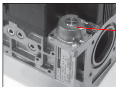
Régulateur de pression (vis de réglage sous le capuchon) XG/XC 120 - 140
