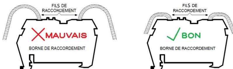
Le raccordement électrique du coffret EXELREG 500 doit être réalisé selon les normes en vigueur.
