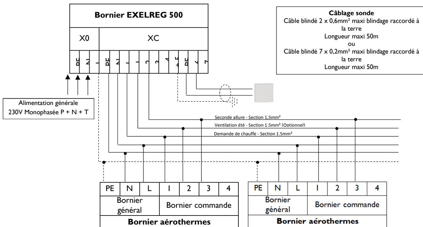
Schéma de raccordement EXELREG 500 pour
