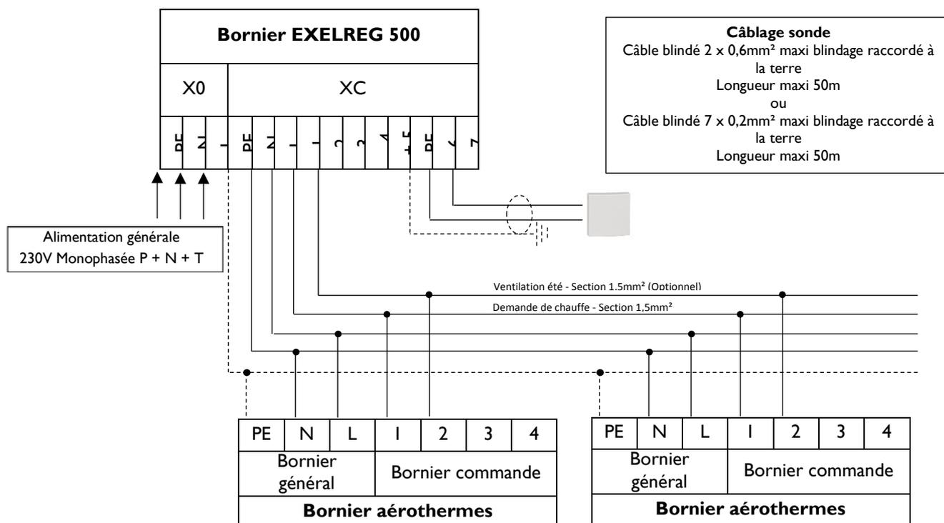
Schéma de raccordement EXELREG 500 pour
