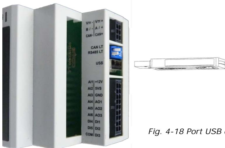
Fig. 4-18 Port USB du régulateur
