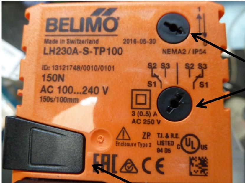
Positionner le volet d'air en position ouverte (allure haute); pour déplacer manuellement la crémaillère du servomoteur maintenir appuyé le bouton poussoir selon le schéma ci-contre. A l'aide d'un tournevis plat fin régler les deux viroles noires de réglage selon les indications du schéma ci-contre. Le réglage est le même pour un modèle HP300 et pour un modèle HP200.
