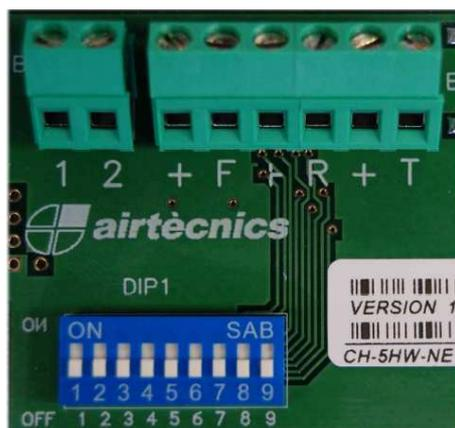
A l'intérieur du boîtier de commande OP-ACREHGA, il y a une série de switches numérotés de 1 à 9 pour :
