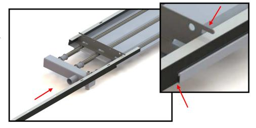
Après avoir inséré les profils latéraux, posez l'isolation avec la feuille d'aluminium sur le côté supérieur, découper délicatement la laine au niveau des points de fixation. Insérez l'isolant sous les profils latéraux
