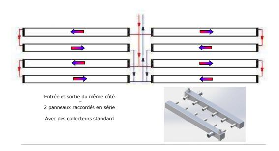
**Figure 3.7**Exemple de circuits avec collecteurs doubles et collecteurs fermés
