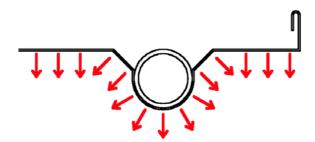
Les tubes en acier galvanisé electro-soudés de 21,3 mm sont soumis à des tests électroniques de soudure et de pression. Les extrémités sont ébavurées, prêtes à être connectées. Les panneaux équipés de tubes standards supportent les pressions jusqu'à 6 bars et une température de fluide maximale de 120°C.
