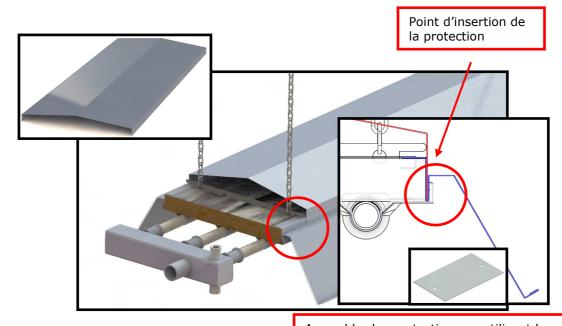
**Figure 3.32** Protection pour panneau 1200mm
