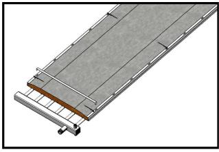
**Figure 3.21**Quantité et positionnement des barres de maintien de l'isolant
