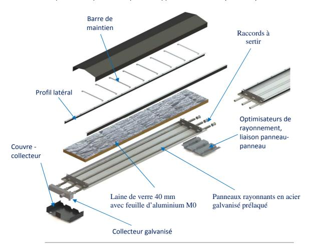
Face émettrice en acier galvanisé prélaqué de 0.6 mm d'une longueur de 2m. 4m, ou 6 mètres et d'une largeur de 300mm, 600mm, 900mm ou 1200 mm. Le profil semi circulaire épousant les tubes de 21.3 mm espacés de 100mm, assure un contact parfait entre les tubes et la face émettrice, ce qui assure un maximum de transfert de chaleur et améliore le rendement de rayonnement de l'appareil.
