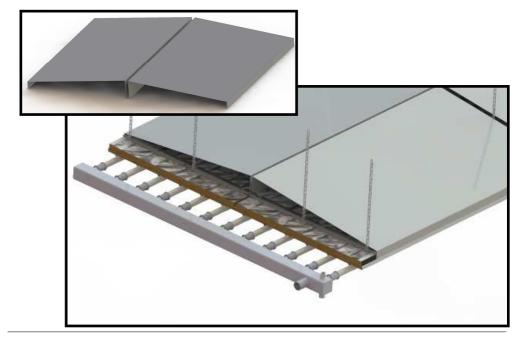
**Figure 3.30** Positionnement des protections anti-ballons
