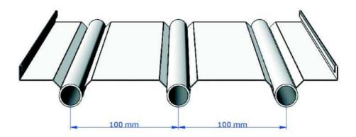
Les panneaux rayonnants, après dégraissage sont peints sur les deux faces avec une peinture poudre époxy-polyester et polymérisés dans un four à 180°C. La peinture est conforme à la norme 76/769/EEC. La couleur standard est le blanc (RAL 9010). Autres couleurs en option.
