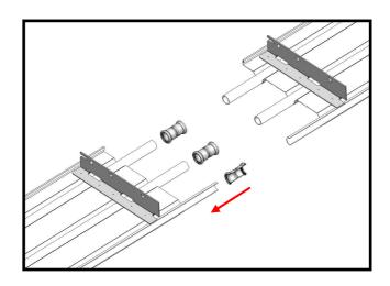
**Figure 3.13a**Montez le raccord avec la pince à sertir et la machoire adaptées.
