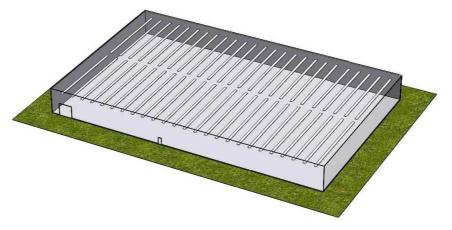
On installe 50 lignes de panneaux de 30 m de long. La puissance installée par mètre sera de 584 W.
