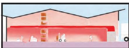
La combustion s'effectue à l'aide d'un brûleur à air pulsé (type chaudière) dans une chambre de combustion. Un groupe moto-ventilateur centrifuge, placé en amont permet le soufflage de l'air repris, qui, au contact de l'échangeur, récupère la quasi totalité de l'énergie consommée.
