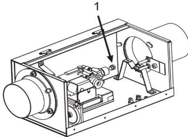
IX.6.1. Retirer le brûleur selon les instructions de la section IX.5. Dévisser l'injecteur du porte injecteur à l'aide d'une clé en maintenant le porte injecteur avec une deuxième clé.
