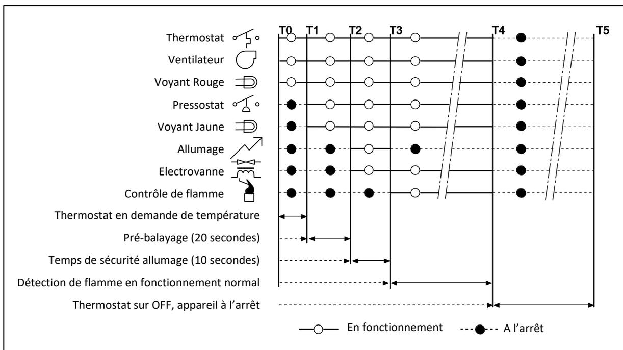
En cas de défaut de détection de flamme durant la séquence T3, l'appareil se met en défaut
