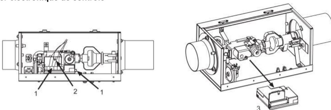
1. Dévisser les deux vis fixant la connexion du câble au boîtier et retirer la connexion du câble.
