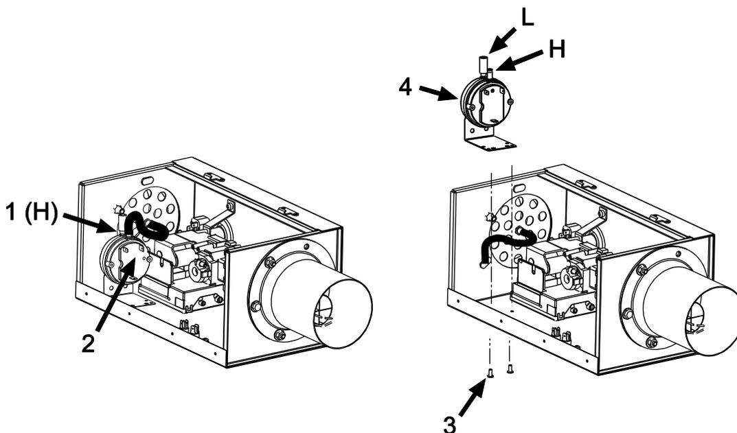
1. Retirer le tube silicone de l'embout marqué 'H' du pressostat et du téton de prise de pression situé au centre de l'amenée d'air.
