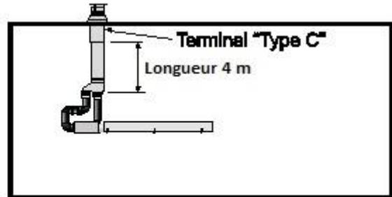
**C32 - Amenée d'air et évacuation verticales en conduit concentrique avec terminal concentrique.**
