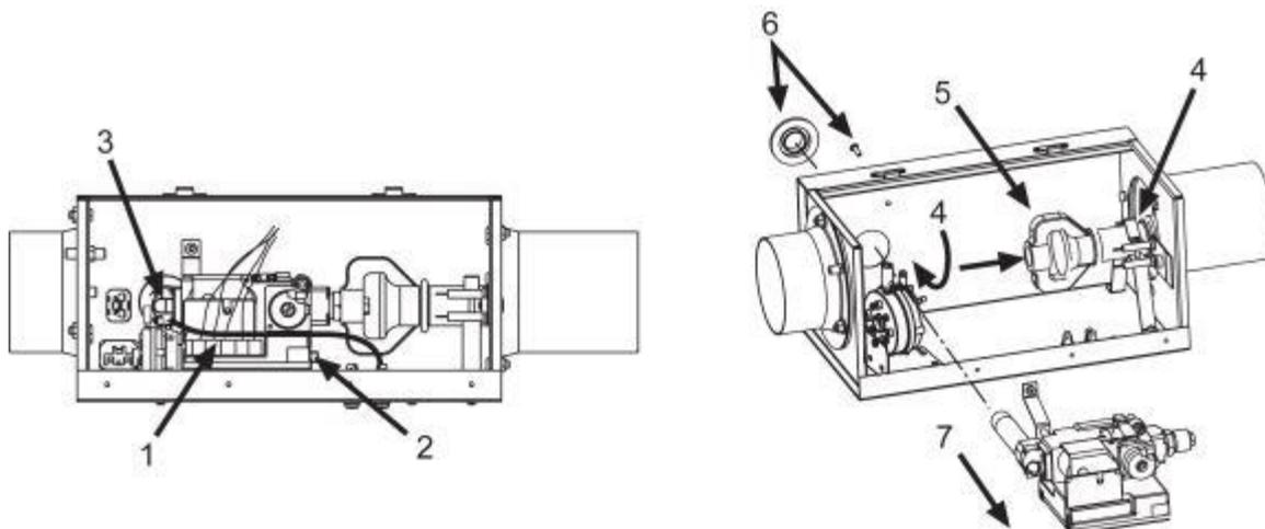
IX.7.1. Retirer le boîtier de contrôle (voir section IX.3) et le brûleur (voir section IX.5.). Déconnecter la connexion gaz du brûleur en conservant le mamelon 1/2" male connecté à la bride coudée (entrée) de l'électrovanne. Dévisser les 2 vis M4 fixant le support de l'électrovanne au carter et retirer l'électrovanne.
