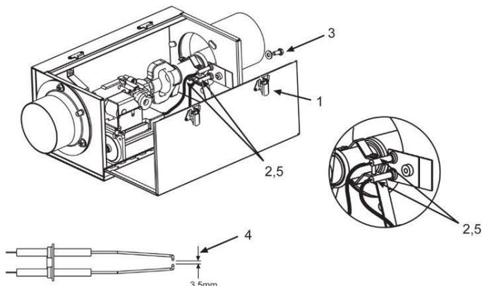
Nota : cette gamme de tubes radiants utilise un système de détection mono-électrode qui permet de concentrer les fonctions d'allumage et de contrôle de flamme sur une même électrode. La deuxième électrode fournit le raccord à la terre pour l'étincelage. Les deux électrodes sont identiques et par conséquent ne nécessitent pas de respecter un sens pour la connexion du fil de terre et du câble haute tension.
