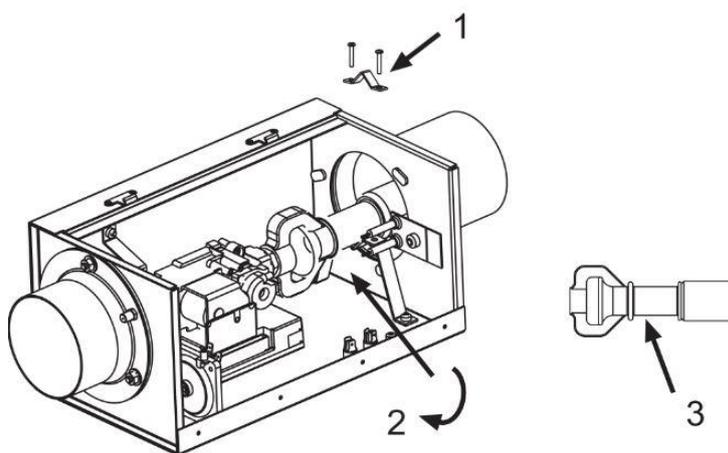
IX.1. Pour remplacer le brûleur, dévisser les 2 vis M4 x 25 du support brûleur et retirer la fixation. Dévisser le brûleur du porte injecteur et retirer le du carter.
