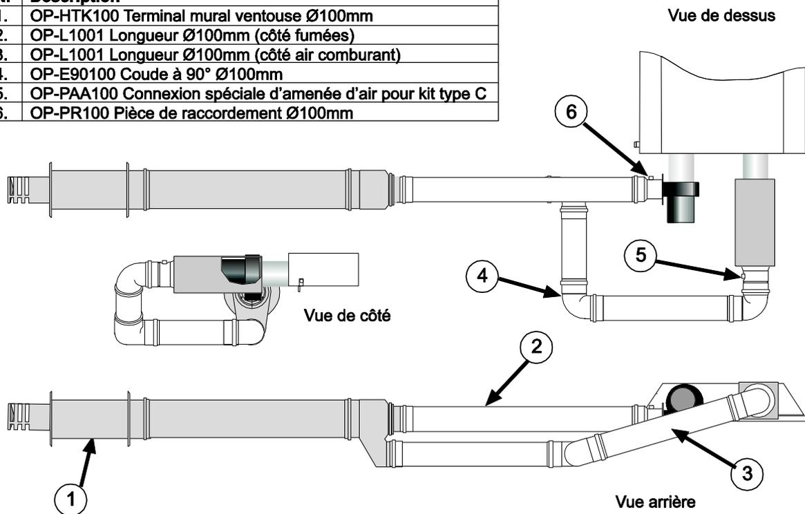
Ci-dessus: schémas de principe pour évacuation et amenée d'air latérales.
